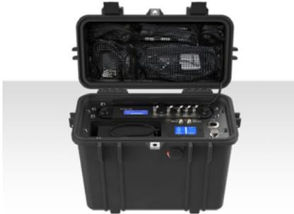
Die mobile Lösung im robusten Gehäuse, konzipiert für die zuverlässige GNSS Störungs-, und Spoofingdetektion an wechselnden Orten und in anspruchsvollen Umgebungen.
